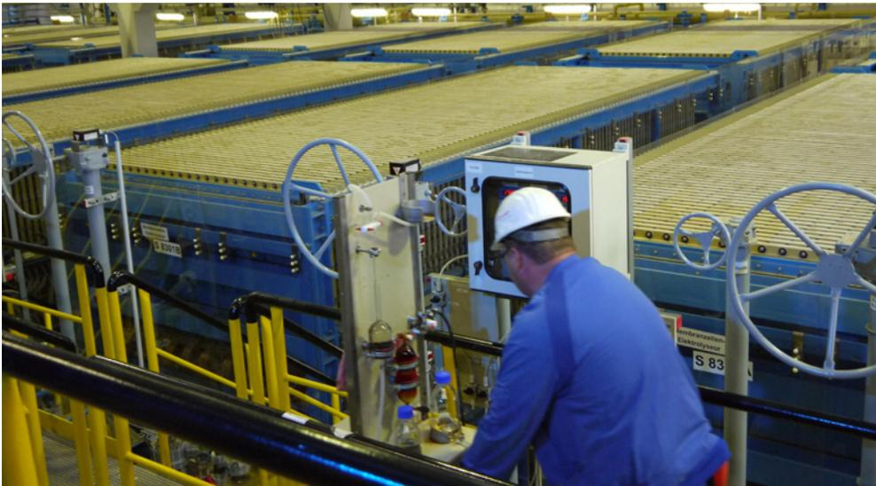
*Vinnolit nutzt zur Herstellung von Chlor und Natronlauge ausschließlich das energieeffiziente Membranverfahren.*
